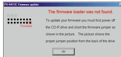
CD-ROM-UPDATE: Erst durch Umstecken eines Jumpers ist ein Firmware-Update beim SCSI-Plextor-Laufwerk möglich.
